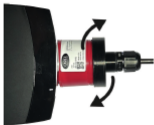
Прикрутите выделенную часть калибровочного комплекта к датчику на калибруемом изделии.
